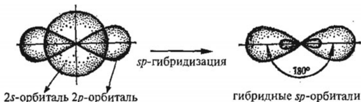
Рис. 9. Образование гибридных sp -орбиталей в атоме бериллия
